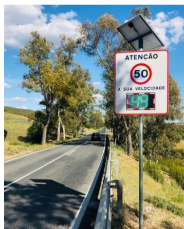
Fig. 31– Painéis eletrónicos para controlo de velocidade na EN122.
