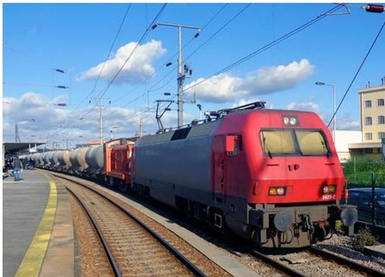
*Figura 5. Comboio de mercadorias composto por locomotiva 5600 e locomotiva diesel 1400 com vagões cisterna, na Linha do Minho.*
