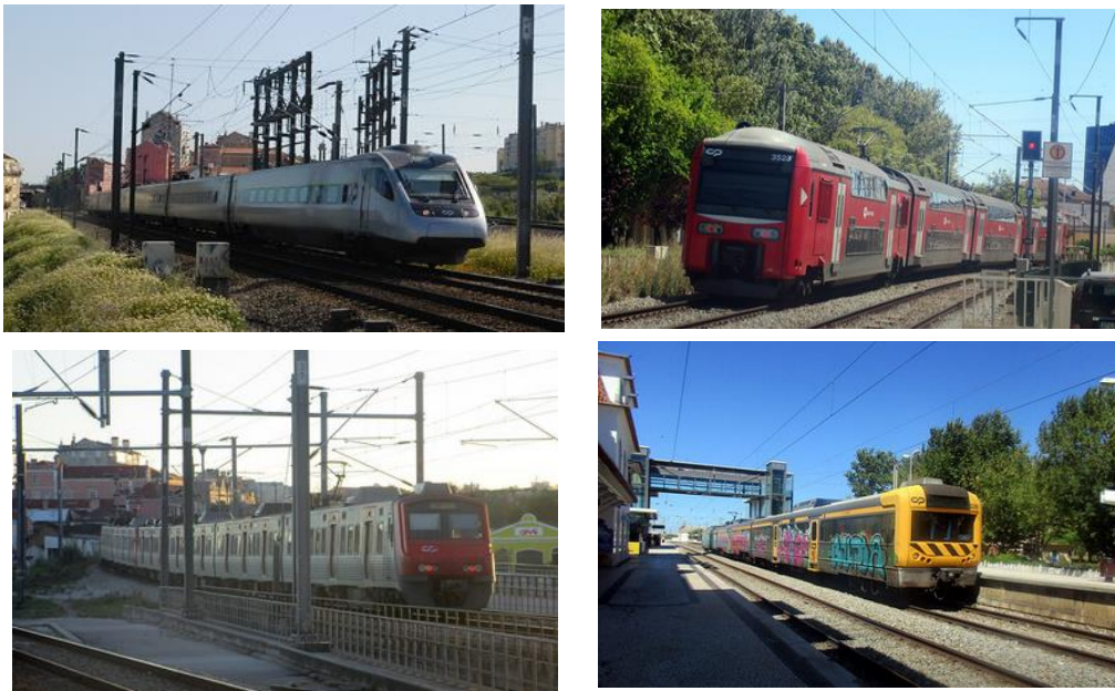
Figura 2. Composições na Linha do Norte I - da esquerda para a direita, topo para baixo: CPA 4000, UQE 3500, UTE 2240, UQE 2300/2400.
