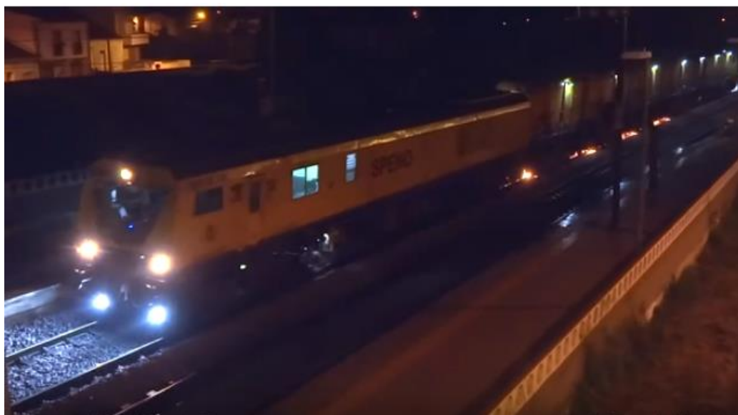
Figura 23. Esmerilagem de carris na Linha do Norte: locomotiva SPENO e unidades de esmerilagem com aspiração (fonte: www.youtube.pt ).
